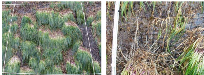
Ancoraggio delle radici alla geogriglia tridimensionale
