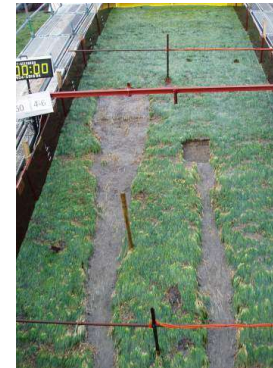
Sezione non rinforzata (formazione di solchi)
